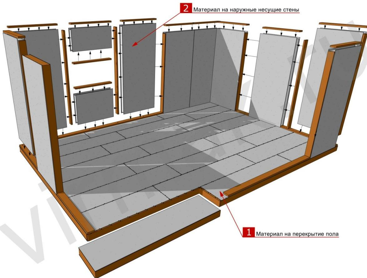
Инструкция по сборке + карта сборки; раскрой СИП панелей (распил СИП панелей согласно карты раскроя); устройство выемки (паза) в СИП панелях; зенкование в СИП панелях ЦСП листов; обrusовка СИП панелей.
